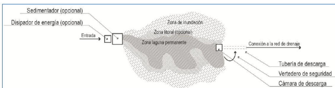
Figura 12: Esquema dels elements principals d'una bassa de retenció a cel obert amb aigua
